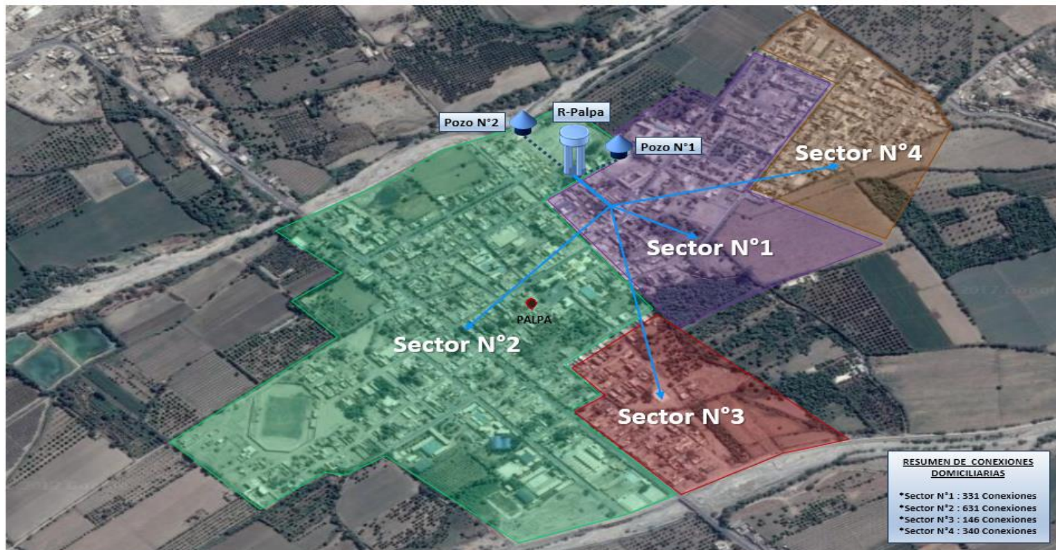
Imagen N° 27: Esquema integral del sistema de agua potable de la Localidad de Palpa
