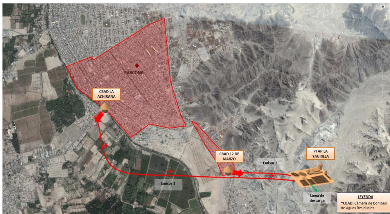
Imagen N° 23: Esquema integral del sistema de alcantarillado de la Localidad de Parcona
