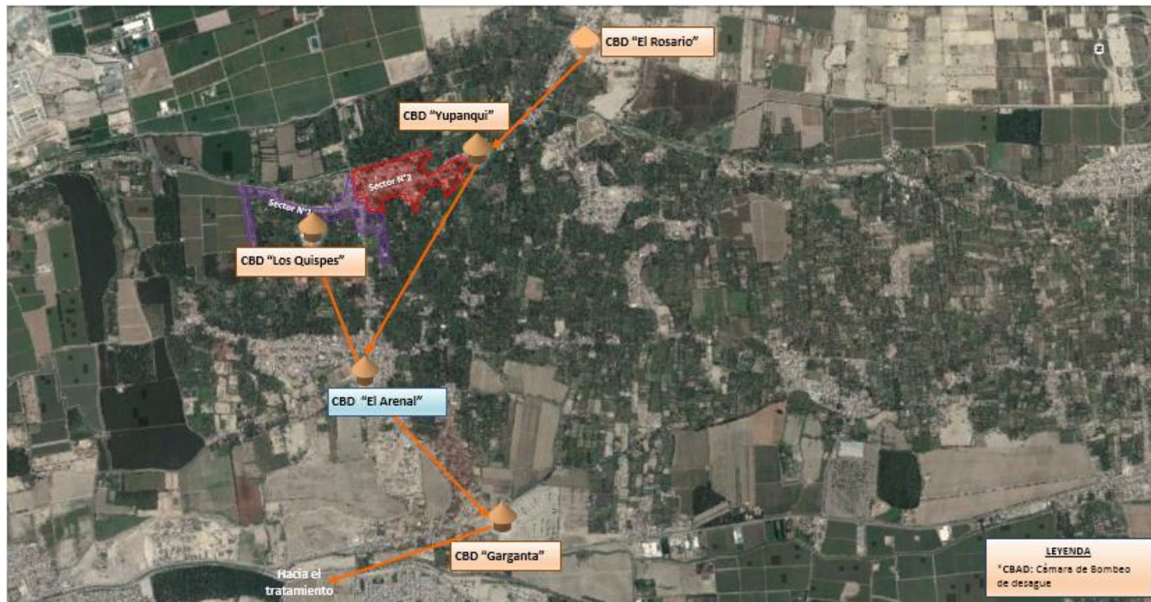
Imagen N° 40: Esquema integral del sistema de alcantarillado de la Localidad de Los Aquijes
