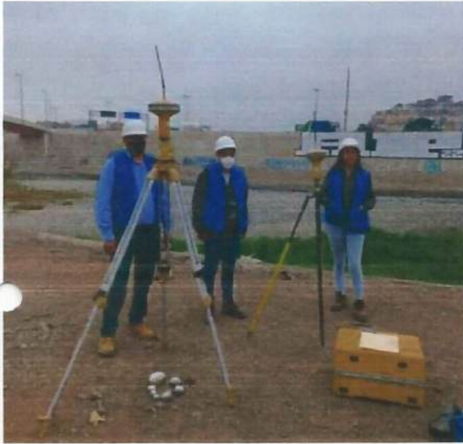
Figura 02: Equipos GPS diferenciales
