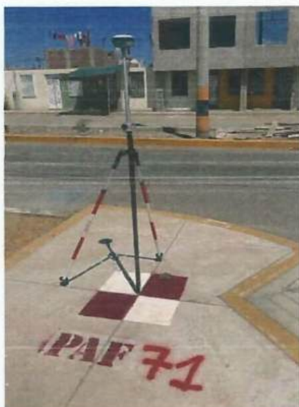
Figura 23: Medición de los PAF
