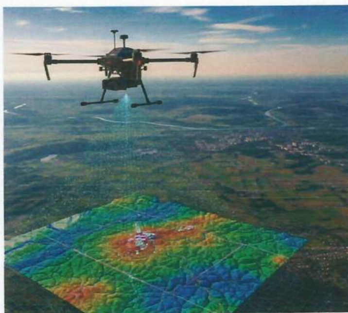
Figura 27: Levantamiento fotogramétrico con dron Matrice 300 RTK Camara P1
