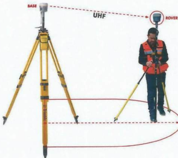
Figura 24: Procedo de corrección se utilizará una Base y Rover
